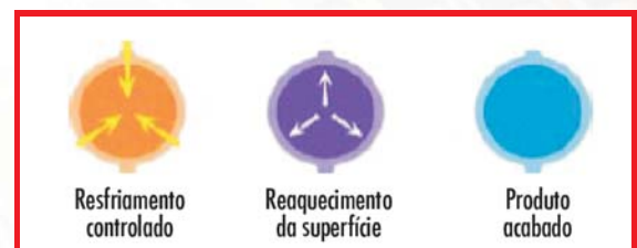
Figura 1 - Processos de resfriamento e reaquecimento (revenimento)
